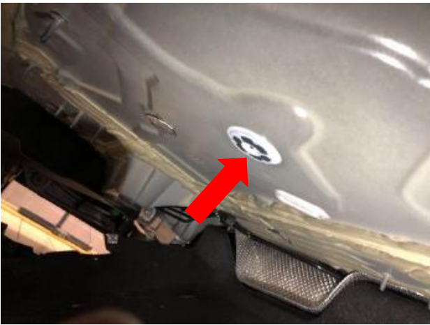
左踏板电机布线：如图此处孔位为左穿线孔
