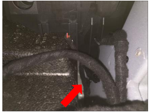
左踏板电机布线：电机线从车内此穿至车身外部
