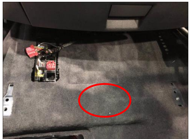
安装 ECU：在副驾驶座椅底下找到放置 ECU 的位置用 3M 胶固定（圆圈）；
