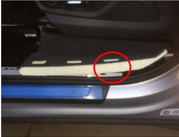
左踏板电机布线：掀开驾驶室垫脚海绵后，可看见车底穿线孔
